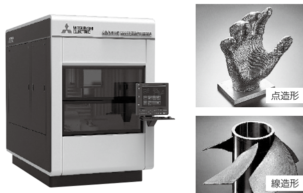
図10. 金属3Dプリンターと点造形、線造形サンプル
