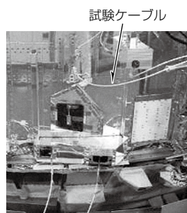
図3. 試験ケーブル接続(従来) (アンテナ取り外し後)
