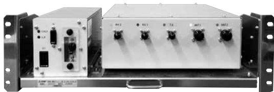
車上無線装置の高周波・電源ユニット
