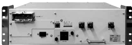
車上無線装置の統合無線ユニット
