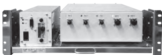
車上無線装置の高周波・電源ユニット
