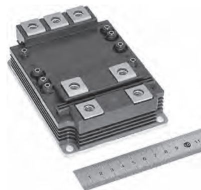
375A/3.3kVフルSiCパワーモジュール
