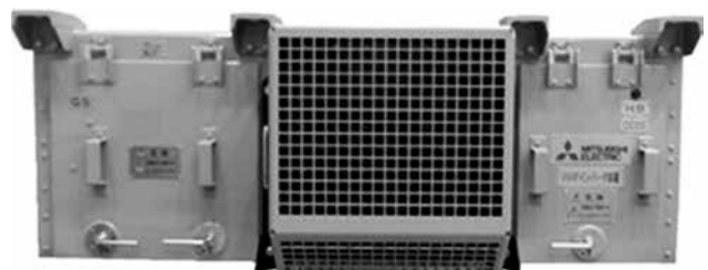
図4. 5000形車両のVVVFインバータ装置
