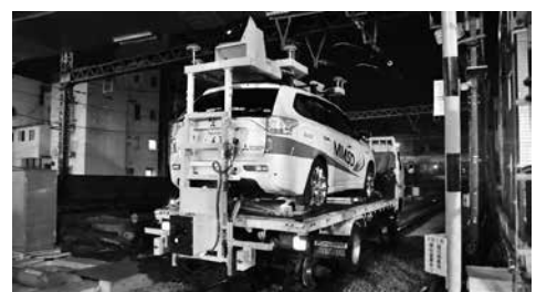
図1. 軌道走行中のMMSD I 計測車両 (軌陸車に搭載)
