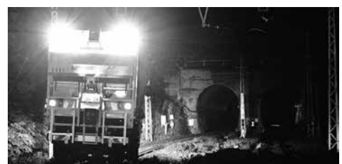
図2. 軌道走行中のMMSD II 計測車両
