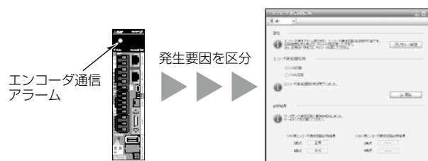
図8. エンコーダ通信回路診断
