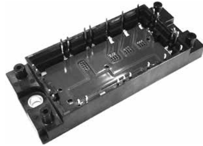
図8. 多層配線基板を用いた試作モジュールの外観写真
