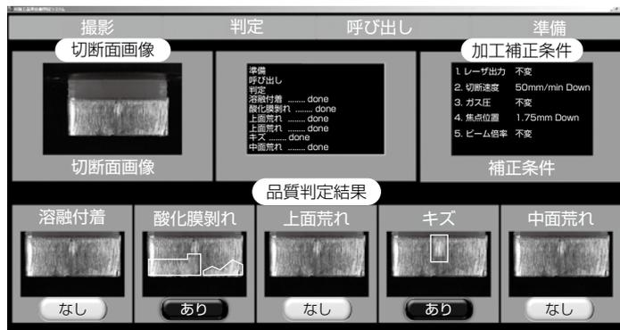
レーザ切断品質のAIを利用した自動判定システム
