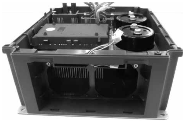
図7. ダクトと一体化したヒートシンク一体型パワーモジュール
