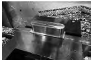
図4. 外面仕上げ加工
