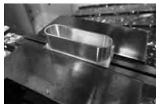
図2. 外面粗加工と内面仕上げ加工
