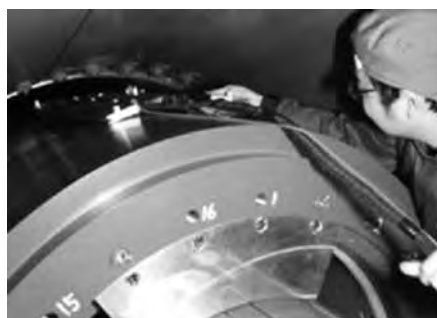
図4. 点検ロボットによるエアギャップへのアクセス
