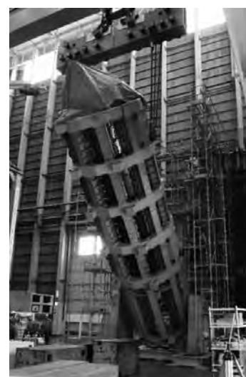
図10. CSの横倒し(提供: QST)
