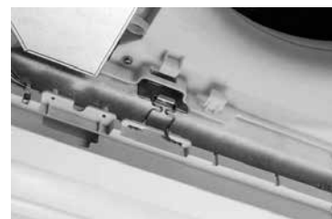
図12. 化粧パネルの仮掛けフック構造
