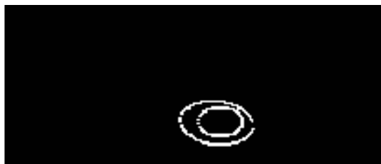
(b) 画像処理による気流等温線
