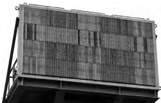
図4. Cバンドフェーズドアレー気象レーダ
