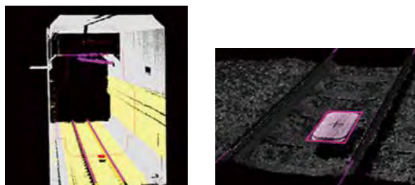
図2. 建築限界解析と地上子の位置計測の一例
