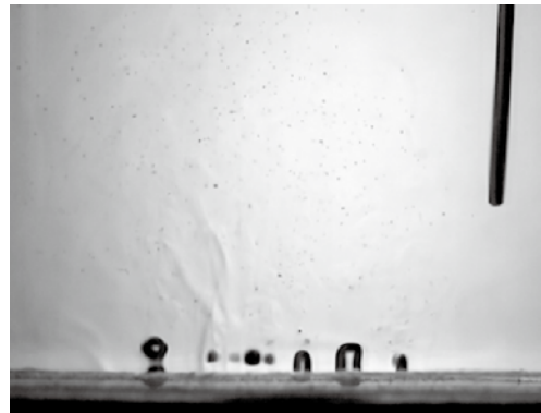
(b) 伝熱面上からの蒸気泡発生
