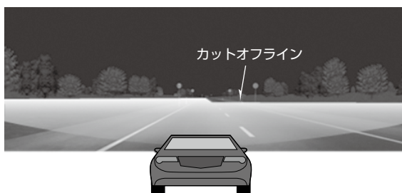
図1. ヘッドライトの配光(ロービーム)
