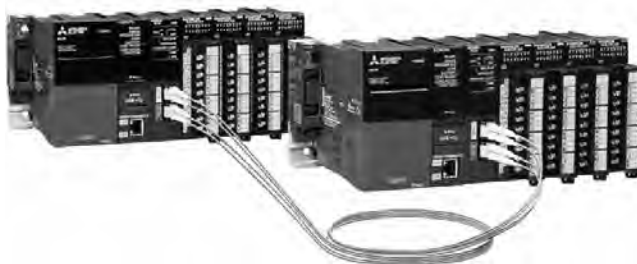
図4. IEC61508 SIL2対応二重化シーケンサ
