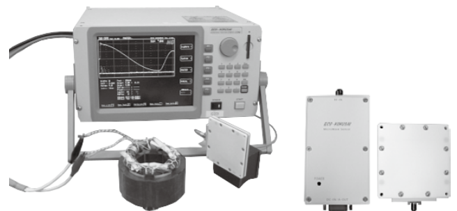
図6. インパルス部分放電試験機(左)と小型化したパッチアンテナと検出器(右)
