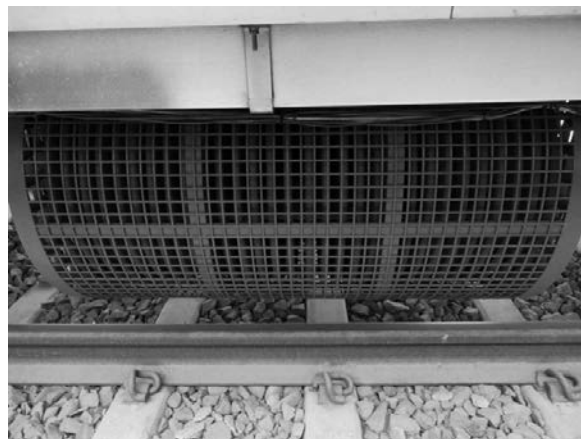
図8. インドデリー地下鉄RS13向け1年走行後の冷却器の状況
