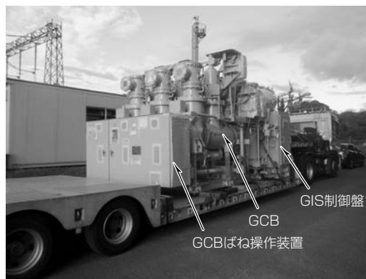
図5. 縮小形300kV H-GISの輸送状況
