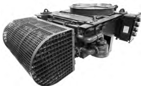
図2. 東日本旅客鉄道(E657)の系特急形交直流電車用自冷式主変圧器
