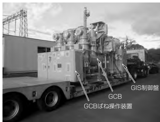
図5. 縮小形300kV H-GISの輸送状況
