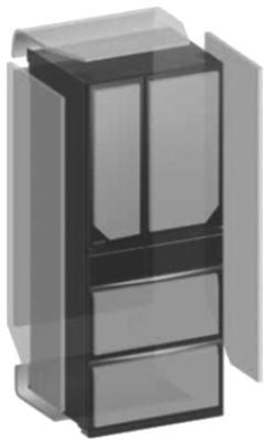
(b) 真空断熱材の効率配置
