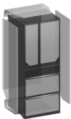
(b) 真空断熱材の効率配置
