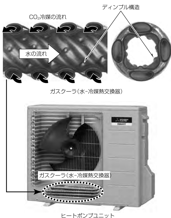
図12. 2018年度モデルのガスクーラのディンプル構造
