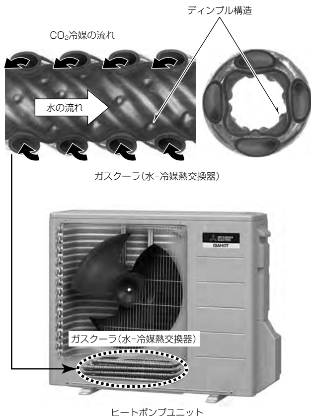
図1. 2018年度モデルガスクーラのディンプル構造
