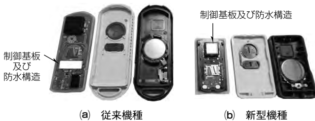
図 10. タグの内部構造
