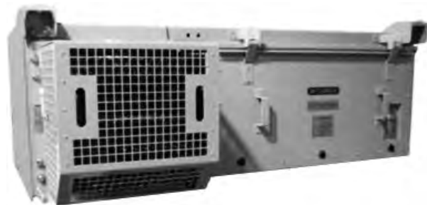
図8. フルSiCパワーモジュール適用VVVFインバータ
