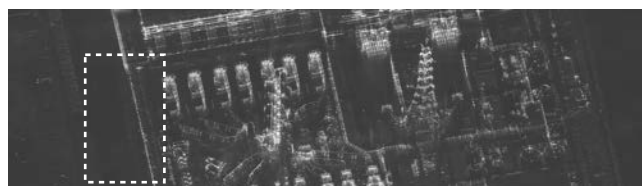
図8. 図7のデータに圧縮センシングを適用して再構成した画像
