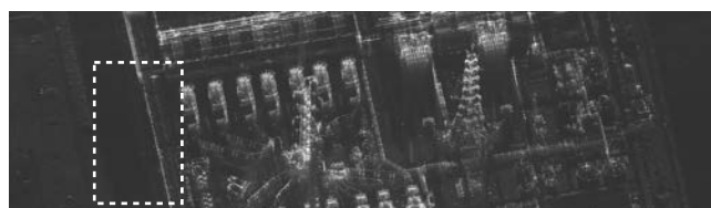
図9. サンプリング定理を満たす(サンプリング率1.2)の航空機SAR画像
