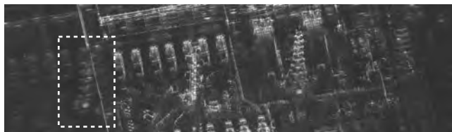
図7. サンプリング定理を満たさない(サンプリング率0.6)の航空機SAR画像
