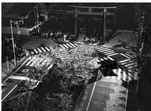
図1. 三菱MMSで計測した点群の例
