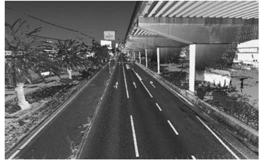
図7. 高精度レーザによる点群
