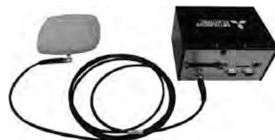
図3. CLASプロトタイプ端末(外形寸法: 178×142×90(mm))
