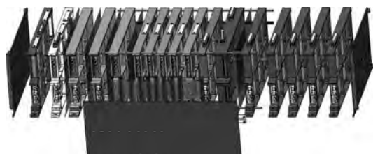
図3. 次世代通信衛星向け電力制御分配器構造
