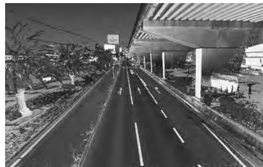
図7. 高精度レーザによる点群
