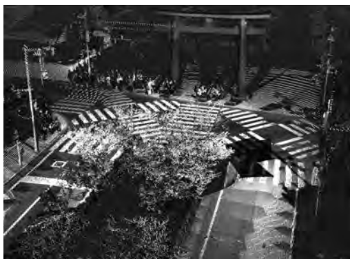
図1. 三菱MMSで計測した点群の例
