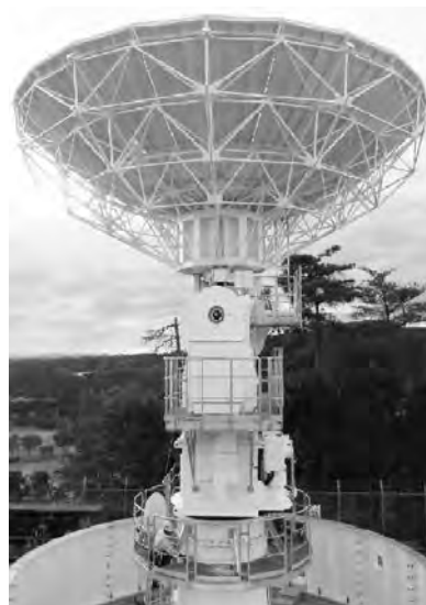
図7. 準天頂衛星システム用3軸駆動アンテナ
