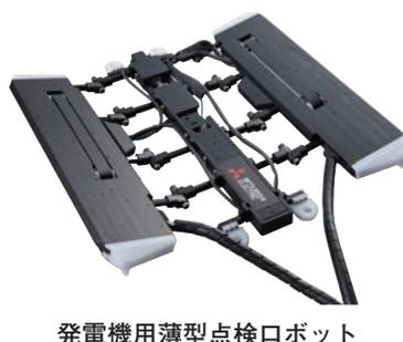
(くさび)の緩み検査)が可能になった。また、発電機コイルを固定するウエッジを打診検査するタッピング機構を独自開発し、振動解析技術と組み合わせることで、ウエッジ緩みの高信頼評価を実現した。
