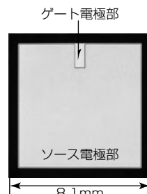
6.5kV耐圧SBD内蔵SiC-MOSFET
