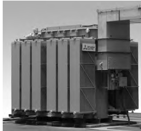
植物油入変圧器(初号器) 3相 60Hz 20MVA 77/6.6kV
