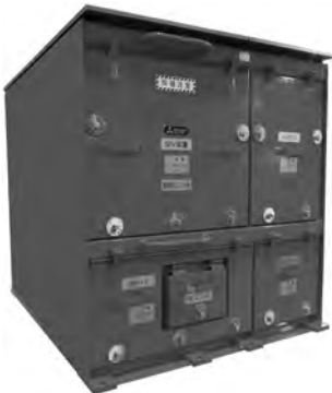
補助電源装置
