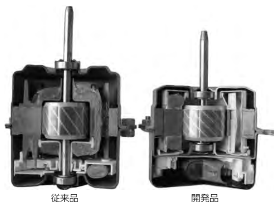
偏心推定技術を適用した換気扇用モータ
