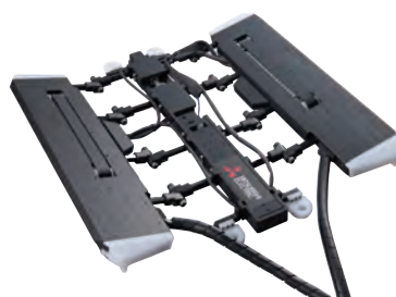
発電機用薄型点検ロボット
