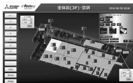
図4. MC Works64の空調管理画面
