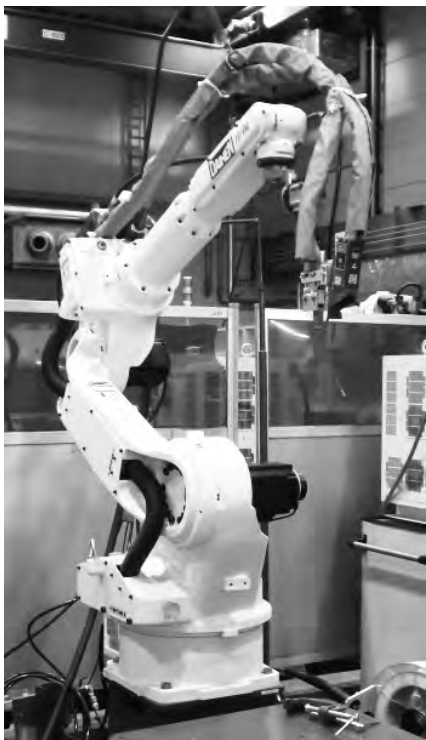
図7. ロボット溶接機
