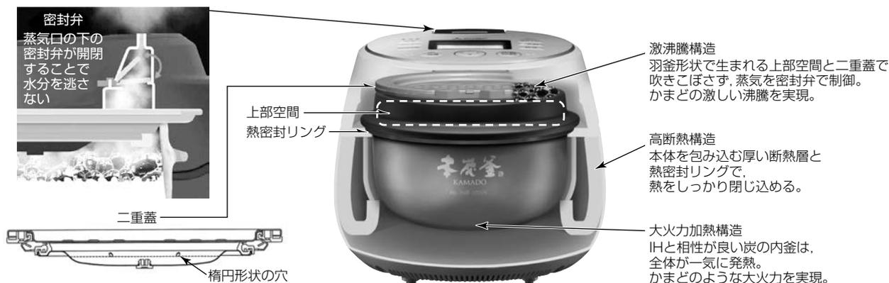
図3. 本炭釜KAMADOの構造的長
