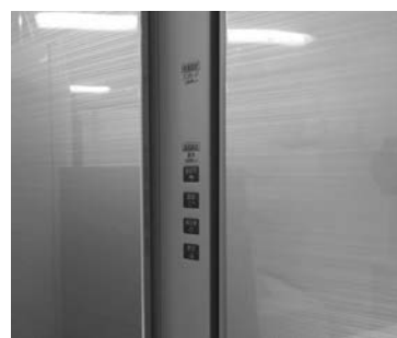
図5. ハンドル埋め込み式の操作表示部
