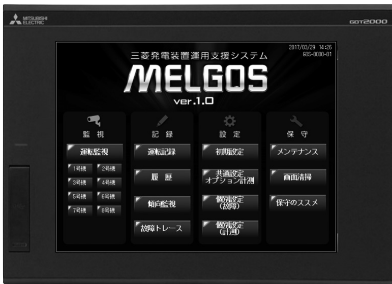
MELGOSタッチパネル式液晶装置 (発電装置最大8台を一括監視可能)
