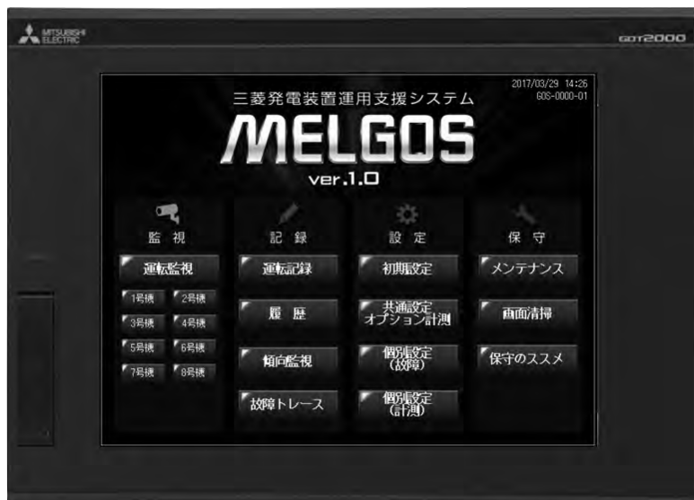
MELGOSタッチパネル式液晶装置 (発電装置最大8台を一括監視可能)
