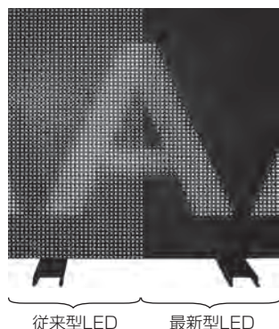
図2. LED搭載パネルの表示コントラスト比較
