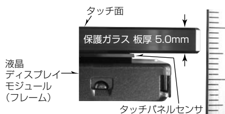
図4. 試作した8.4型タッチパネル搭載製品の断面図
