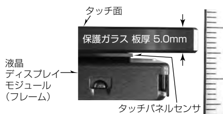
図4. 試作した8.4型タッチパネル搭載製品の断面図
