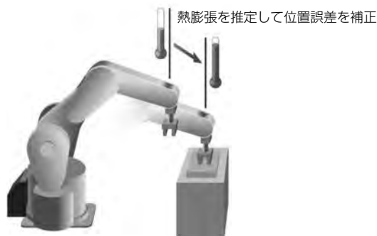
図1. ロボットアームの位置誤差補正
