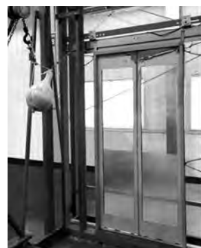
図7. 乗場ドア耐衝撃荷重戸外れ試験装置
