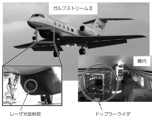
図5. 航空機へのドップラーライダ搭載 (1)
