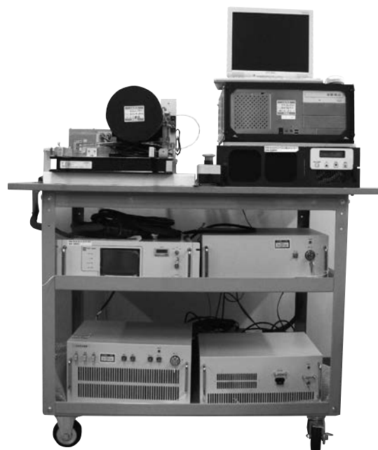
図4. 2011年度開発の航空機搭載ライダ (3)
