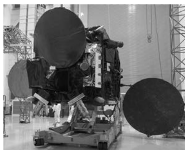
展開アンテナ3枚のうち、2枚の展開試験写真を示す
