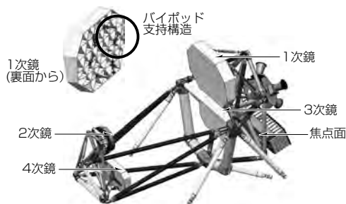
図8. 高安定鏡筒とミラー支持構造
