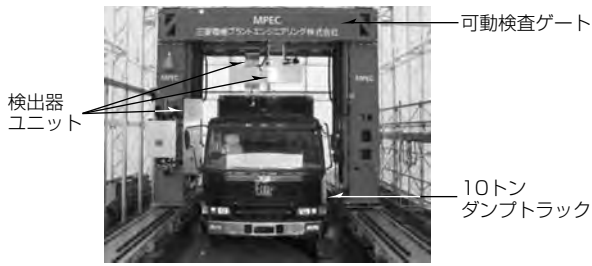
図6. 車両放射能汚染検査装置
