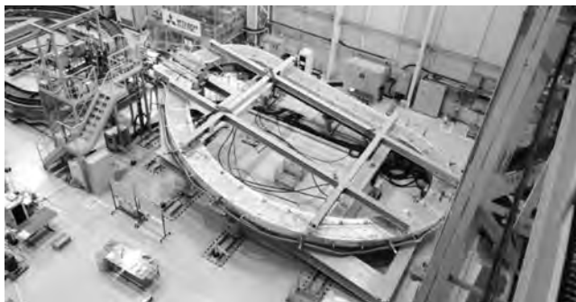
図10. DP含浸装置全景(含浸容器を傾斜させた状態)
