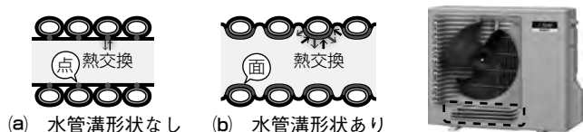
図3. 水冷媒熱交換器の断面図
