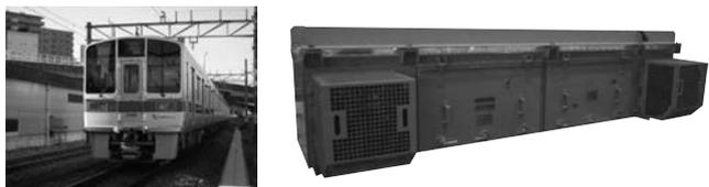
図2. 1000形更新車両とVVVFインバータ装置
