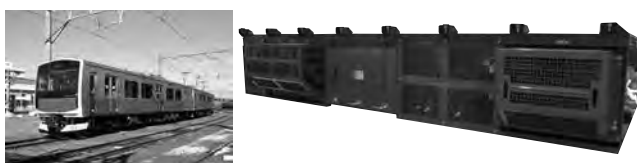
図3. EV-E301系車両と電力変換装置
