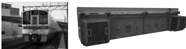
図2. 1000形更新車両とVVVFインバータ装置
