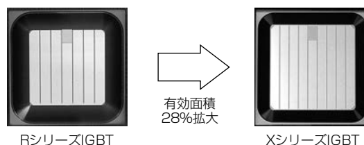
図2. IGBTチップの有効面積拡大
